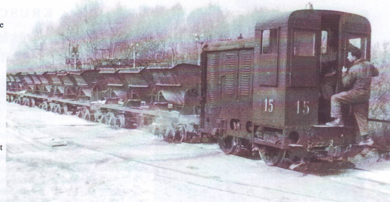
▲ Le Dick Kerr reprend les wagons déversés dans le transporteur aérien
