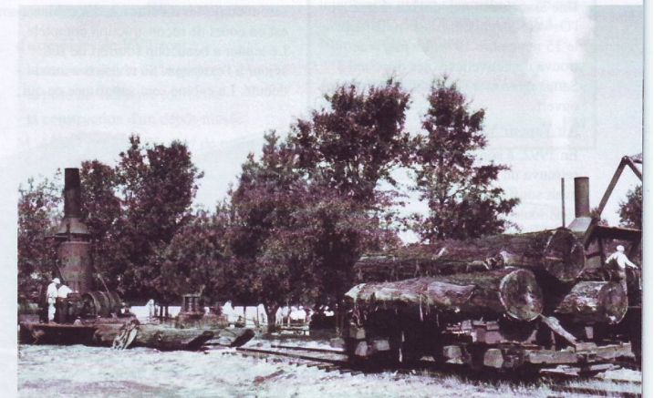
▲ Treuil à vapeur de débardage tirant une rame chargée de grumes
