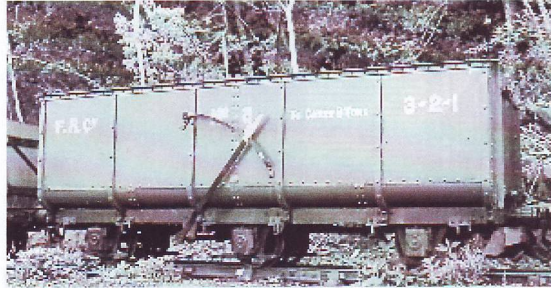
◀ Voici donc le fameux wagon à trois essieux articulés, système James Cleminson construit en 1880
