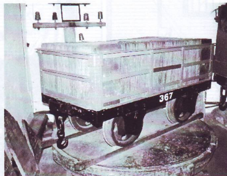
▲ Voici un wagon pour le transport de l'ardoise. Il s'agit d'un modèle métallique construit dans les débuts de l'exploitation du réseau. Il est posé ici sur une plaque tournante datant des origines de la ligne. Notez le profil du rail. (Aout 1994)
