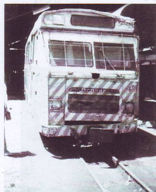
▲ « Bus rail » en service. Caisse d'origine BROSEL, constructeur d'autobus et d'autocars belges.
